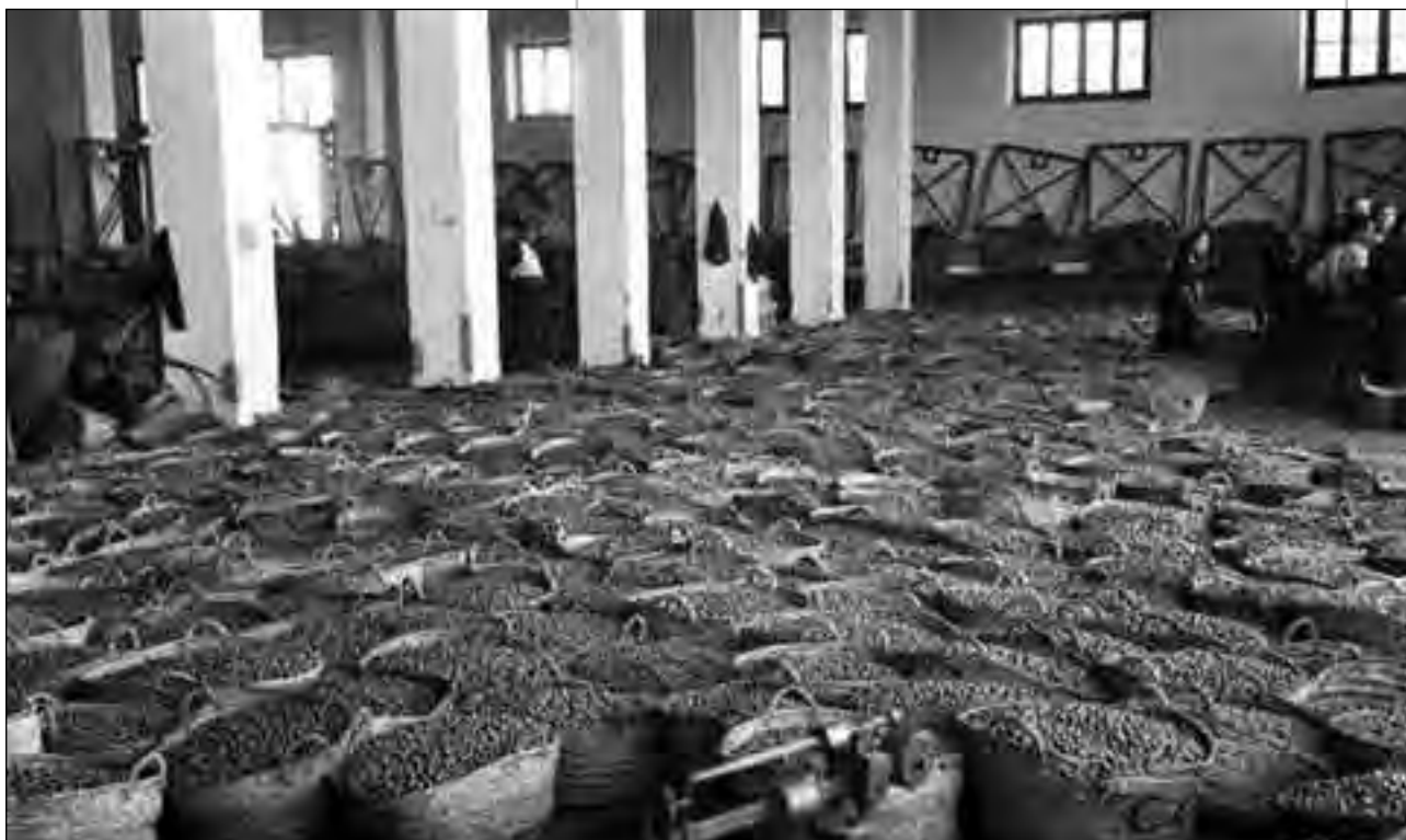
Las aceitunas en espuestas preparadas para su cocción en el Almacén Nuevo , hacia 1962. Al fondo, los pilones llenos de cáustica. A la izquierda, el maestro cocedor controlando toda la operación de cocido.
