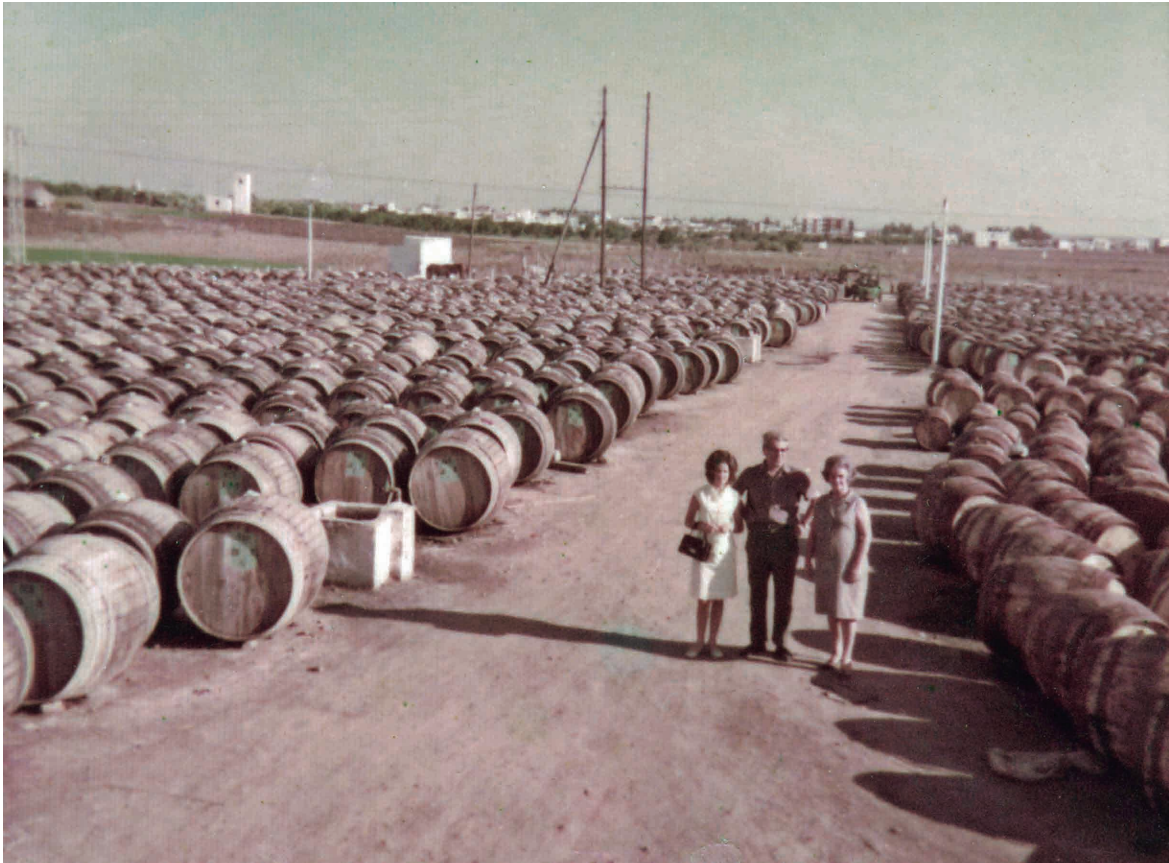
Bocoyes alineados en el patio en periodo de fermentación. Se puede observar en los de la izquierda el característico “copete”. (Almacén de “El Pollo”, en Coria del Río).
