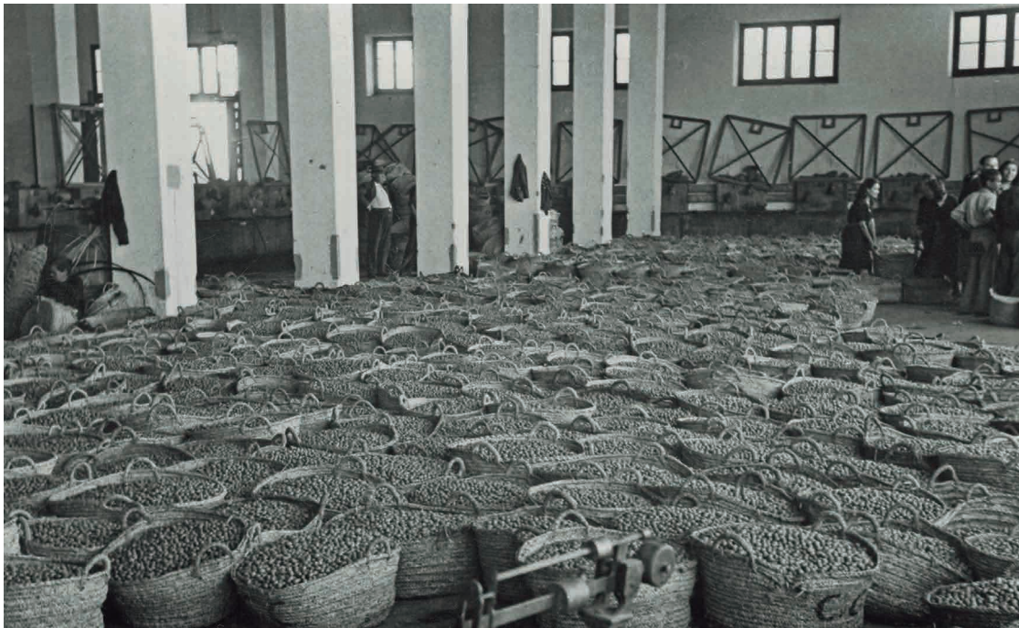
Las aceitunas preparadas en las espuertas para su cocción. Al fondo los pilones de salmuera con las rejas de malla que servían para sumergirlas completamente. (Almacén Nuevo, en Coria del Río).
